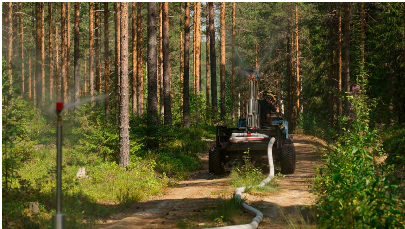
Kuva 8. Kuvassa Marko Hassisen kehittämä sadetinkärry, jonka avulla saadaan luotua nopeasti sammutus- ja rajoituslinja maastopaloihin. Kuva: Luomustudio Productions Oy.
