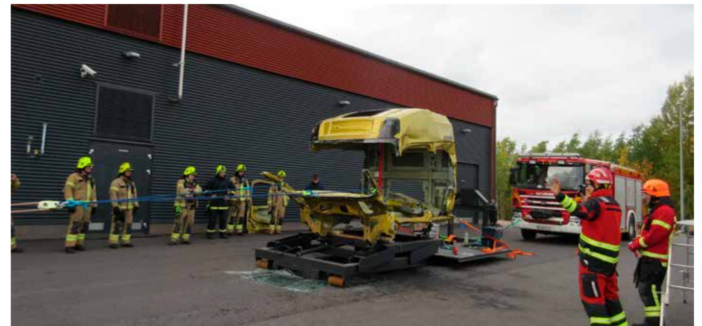
Kuorma-auton ohjaamon etuosan taitto eteenpäin ketjuvedolla koulutustilaisuudessa Luolalan paloasemalla 4.10.2017. Harjoituksessa ohjaamo on kiinnitettyä hankkeen yhteydessä rakennettuun ketjuvetosimulaattoriin. Kuva: Markku Haikonen
