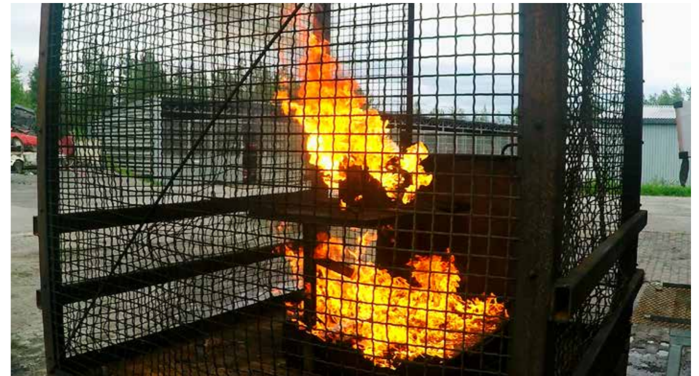
Hybridiauton akun palovaiheessa sylinterikennojen elektrolyytti kaasuuntui kuumetessaan ja syttyi purkautuessaan palamaan. Kuvaaja: Markku Haikonen
