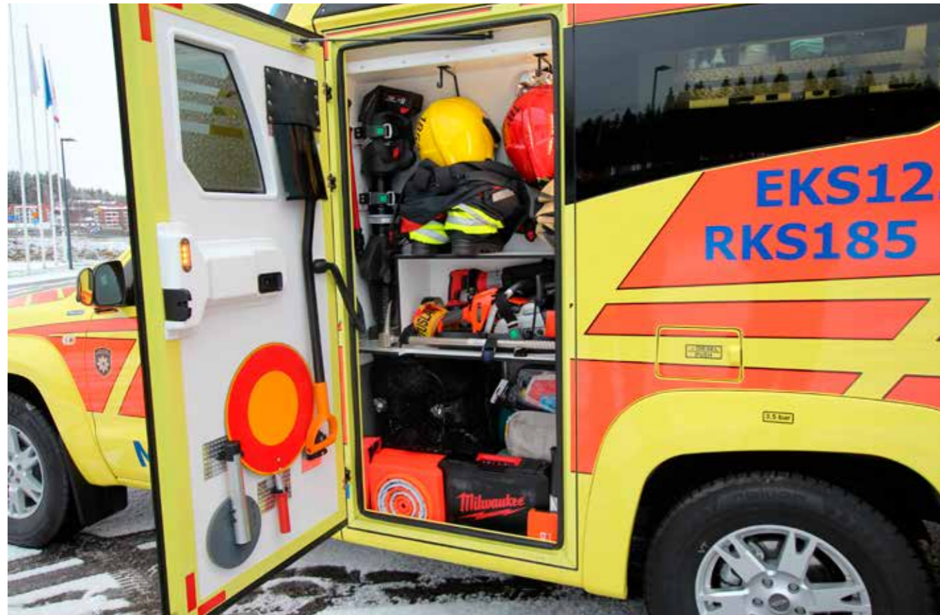
Keski-Suomessa käytössä olevassa moniammatilliseen toimintaan suunnitellussa ajoneuvossa on erilliset tilat pelastustoimen kalustolle. Kuva: Tamlans
