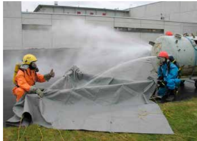
Kuvia kemikaalionnettomuusarjoksesta. Vasemmalla vuoto rajoitetaan päästöaineen talteenotolla säkkiputkeen. Oikealla vuoto, jossa muodostuu lammikko ja ainetta purkautuu kaasuna. Kuva: Ilmatieteen laitos
